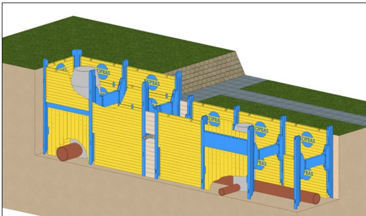
Figur 5 Eksempel på panelsikring hvor panel kan justeres etter hindringer som f.eks rør, og tilpasses høydeforskjeller i bergnivå.
